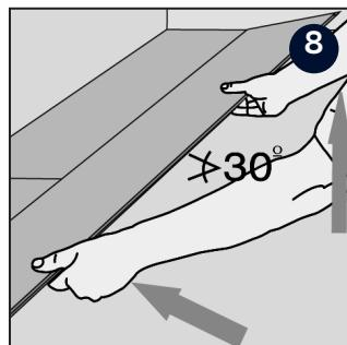
Heben Sie die Dièle (zusammen mit der vorher gelegten Dièle in der gleichen Reihe) etwa 30 mm an der Vorderkante an und drücken Sie diese in die Dielenreihe hinein. Wenn die Längskanten aufeinander stoßen, legen Sie die Dielen auf den Boden.
