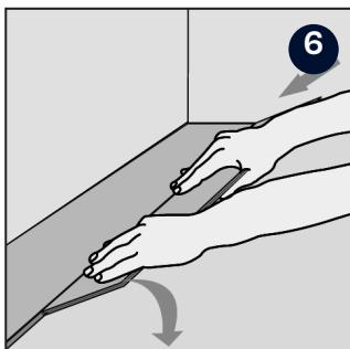
Drücken Sie die Längsseite der ersten Dièle der zweiten Reihe im Winkel gegen die davor liegende Dièle. Pressen Sie die Dièle weiter nach vorne und legen Sie sie gleichzeitig an den Boden an.
