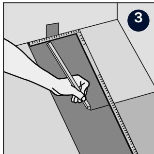
Legen Sie die letzte Dièle mit der Unterseite nach oben, die Stirnseite ohne Verriegelungsleiste der Wand zugewandt. Der Abstand zur Wand soll ca. 10 mm betragen. Markieren Sie die Stelle, an der die Dièle abgesägt werden soll.
