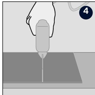
Sägen Sie die Länge zu, am besten mit Hilfe einer Stichsäge. Legen Sie die Dièle mit der Dekorseite auf die Sägeunterlage. Als Alternative kann eine feingesäzte Handsäge benutzt werden, aber dann muss die Dekorseite nach oben zeigen.
