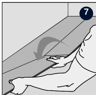
Drücken Sie stirnseitig die nächste Dièle schräg in die erste und legen Sie diese auf den Boden. Dabei soll die Längsseite auf der Verriegelungsseite der vorhandenen Dièle gelegt werden.
