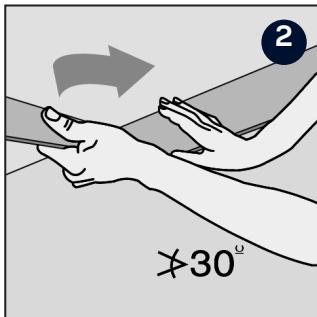
Drücken Sie die nächste Bodendiele im Winkel an die erste Dièle und drücken Sie anschließend die Dièle auf den Boden. Verfahren Sie in der gleichen Weise mit der gesamten ersten Reihe.
