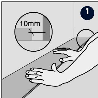
Legen Sie das erste Element entlang der Wand aus. Dabei werden die Federseiten gegen die Wand gelegt. Achten Sie darauf, dass Sie ca. 10 mm Abstand zwischen der Stirnseite der Dièle und der Wand haben. Der Abstand der Längsseite von der Wand (ca. 10 mm) kann später festgelegt werden, wenn drei Reihen verlegt worden sind.
