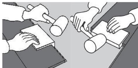
Die Elemente der letzten Reihe werden zugeschnitten und passgenau mit 10 mm Abstand zur Wand eingesetzt.
