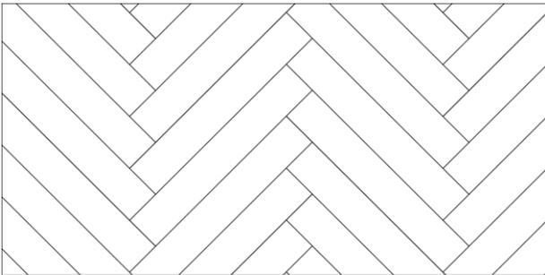
Chevron: Hier gibt es linke und rechte Stäbe/Elemente, die sich abwechselnd im Paket befinden. Beim Anlegen der ersten Reihe hilft Ihnen eine rostfreie Schneideschiene/ein Stahlband. Hierbei muss darauf geachtet werden, dass es geradlinig und exakt ist.
