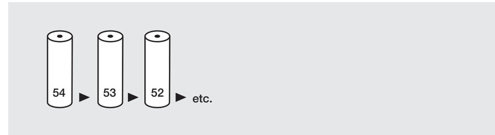
Die Bahnen sind zu stürzen und mit Doppelschnitt zu verlegen. Stirnnähte sind zulässig und bei einwandfreier Verlegung praktisch unsichtbar.
