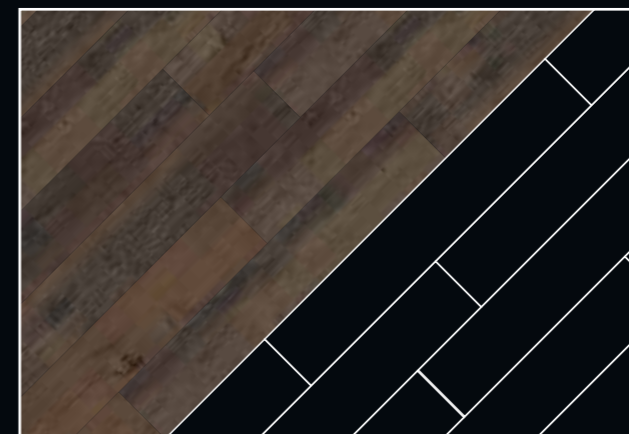
Diagonale Verlegung Diagonal lay
