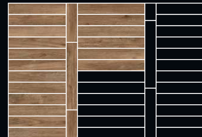
Leiterboden-Verlegung Ladder pattern
