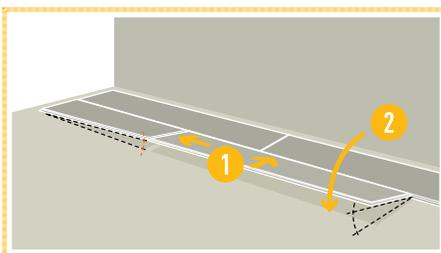
3. Bei den folgenden Dielen verbinden Sie zunächst die kurze Seite, dann die Längsseite, indem Sie die Diele anwinkeln.
