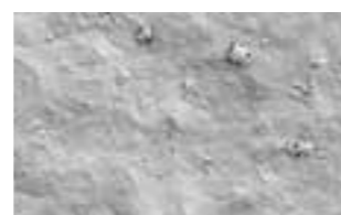
Tarkett xf 2 ™, vor Abriebtest
