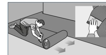
· Verlegung der Bahnen. Nahtkanten sind grundsätzlich zu beschneiden.
