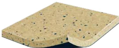
Elastischer Vinyl-Bodenbelag nach EN 649, homogen, einschichtig, richtungsfrei, mit schwarzen leitfähigen Einstreuungen, durchgehend marmoriert, elektrostatisch permanent leitfähig ausgerüstet (EN 1081 -  $10^4 \leq Rt \leq 10^6 \Omega$ ) durch leitfähige Rückenbeschichtung, in Bahnen lieferbar.
