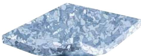
Elastischer Vinyl-Bodenbelag nach EN 649, homogen, einschichtig, richtungsfrei, fein geadert mit farbigen Chips, durchgehend marmoriert, leitfähig ausgerüstet (EN 1081 -  $10^4 \leq Rt \leq 10^6 \Omega$ ), in Fliesen lieferbar.
