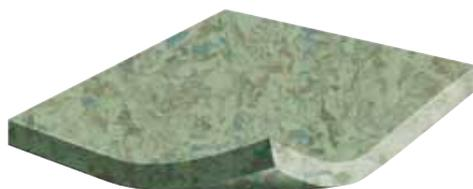
Elastischer Vinyl-Bodenbelag nach EN 649, homogen, einschichtig, richtungsorientiert, fein gewolkt, durchgehend marmoriert, ableitfähig ausgerüstet (EN 1081 -  $10^6 \leq Rt \leq 10^8 \Omega$ ), in Fliesen und Bahnen lieferbar.
